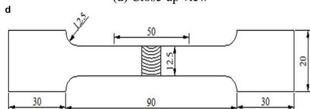
(d) Dimensions of flat tensile specimens (in 'mm')
