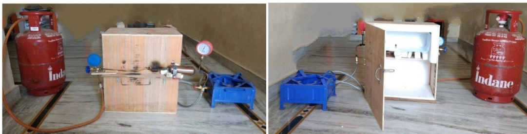
Fig .3 Actual Setup of LPG Refrigerator
