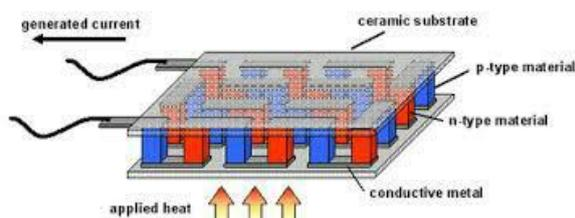
Fig. 1 Thermoelectric module<sup>[1]</sup>
