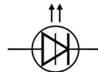
Fig. 3. Laser Diode
